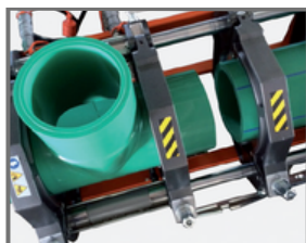
soldadura a tope
